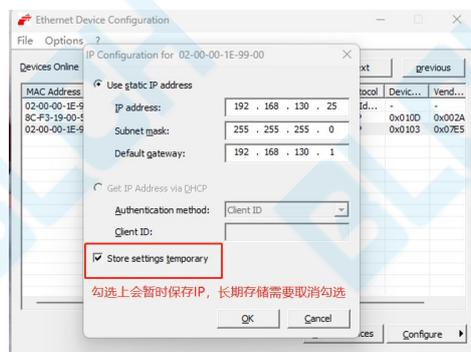
也可以使用 TIA 博图软件选择自己的电脑网卡在线访问设备, 设定模块的 IP 地址和名称。这里模块的 IP 地址分配为 192.168.130.25 与电脑和 PLC 在同一网段, 模块名称为 pn1 (用
