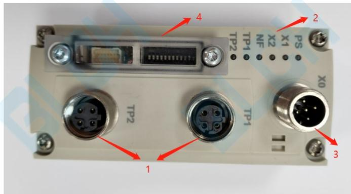
1 网络接口（网络端口 TP1/TP2，现场总线接口）
